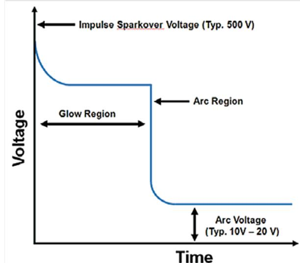
图10. GDT特性波形
