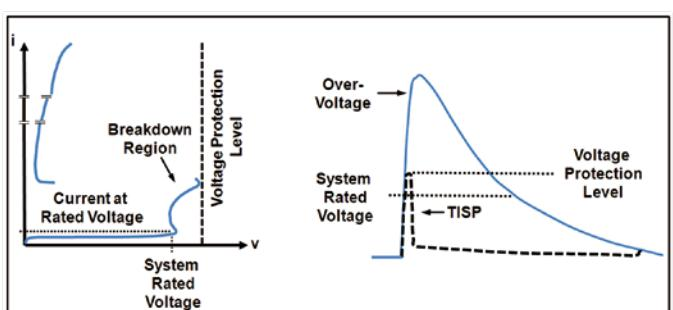
图9. TISP切换特性和电压限制波形
