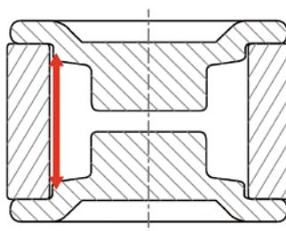
Bourns®已经开发了一个创新的FLAT®皱接工艺GDT,有效地减少了GDT的尺寸大小,同时保持其电气隔离的能力和电流处理能力。基于FLAT®横截面图显示了绝缘用红色通道。Bourns®的FLAT®GDT技术的关键设计特征是弯曲爬电路径,允许GDT“皱接(squeezed)”。当比较Bourns®FLAT®工艺GDT的皱接的通路和传统GDT长度将是相似的。然而,Bourns®FLAT®工艺GDT通过皱接配置,高度、重量和整体体积明显减少。
