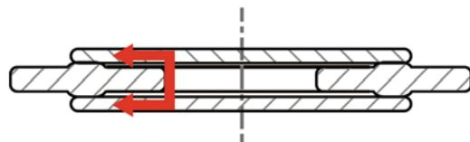
图 基于FLAT®皱接工艺GDT的内部截面
