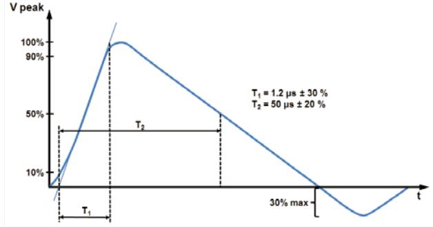
图3. IEC61000-4-5电涌1.2/50 波形
