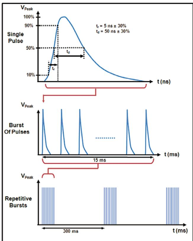
图2. IEC61000-4-4 EFT 50Ω 负载波形
