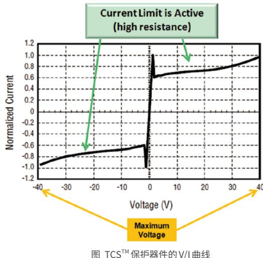
图 TCS™ 保护器件的V/I曲线
