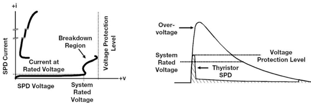
图 TISP<sup>®</sup>器件切换浪涌能量V/I曲线及电压限制波形图
